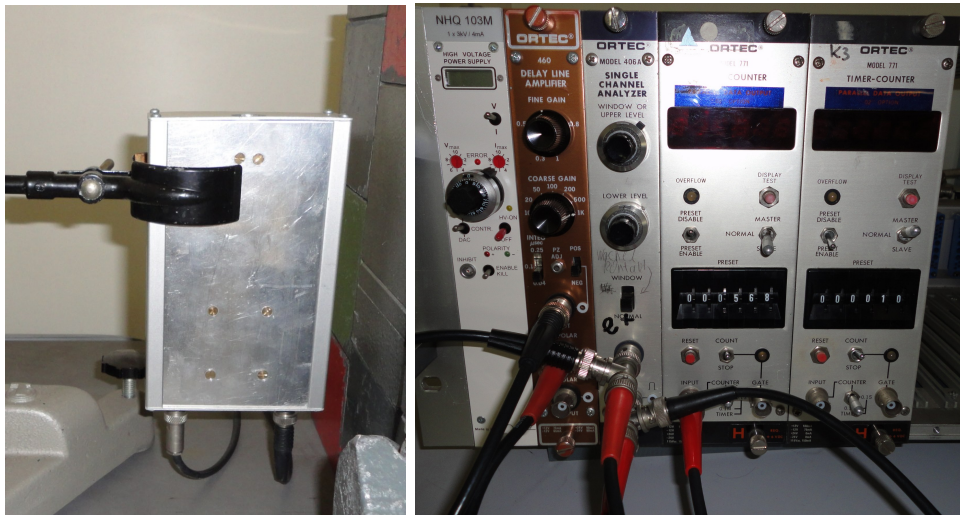
Abbildung 5.2: Foto des Geiger-Müller-Zählers in einem Metallgehäuse (links) und der Ausleselektronik (rechts)
